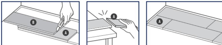
**REMARQUE :** pour les formes irrégulières, chauffer les planches à l'aide d'un pistolet à air chaud et les couper à la dimension voulue.
